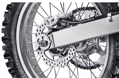
Figura 24 - Freio a disco traseiro da motocicleta. 24
