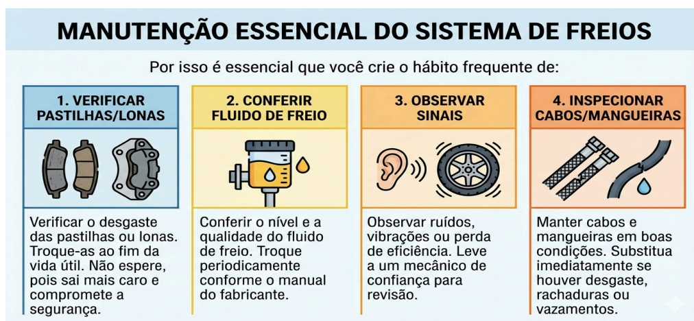
Figura 25 – Manutenção do sistema de freios 25
